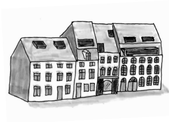
Slechte voorbeelden van dakramen en dakkapellen op de voor- en achterzijde van monumenten
